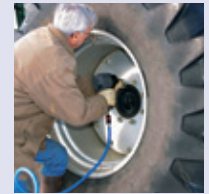
Schlagschrauber 3/4" Profi 300-400 l/min, 6-7 bar
