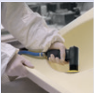
Schwingschleifer 190 l/min, 6-7 bar
