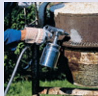
Sandstrahlen 50-500 l/min, 5-6 bar
