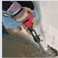
Abbruchhammer mittel 290 l/min, 6-7 bar
