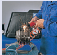
Schnellschleifer 180 l/min, 6-7 bar
